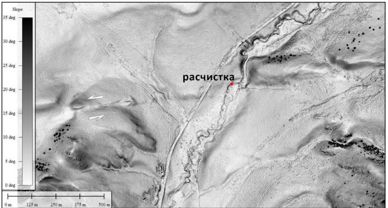
Рис. 10. Активный разлом с левосдвиговой компонентой смещений. Центрально-Тувинская система разломов, район г. Чадан. Цифровая модель рельефа по данным аэрофотосъемки с БПЛА с положением расчистки.
