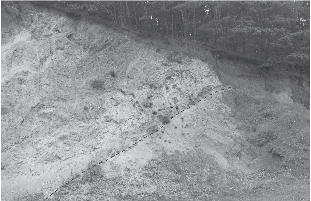
Рис. 7. Надвигание эоценовых пород на четвертичные отложения по северной ветви Памбак-Севан-Сюникского разлома севернее с. Лермонтово, долина р. Памбак. Пунктиром показан надвиг
