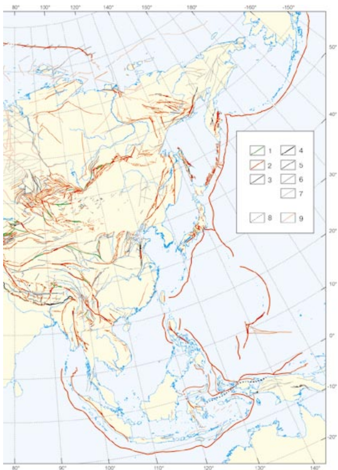
4–7 – скорость движений, мм/год: 4 – V \geq 5 , 5 – 1 \leq V < 5 , 6 – V < 1 ; 7 – V \ll 1 , 8 – разлом предполагаемый; 9 – глубинный разлом, выраженный на поверхности косвенными признаками
