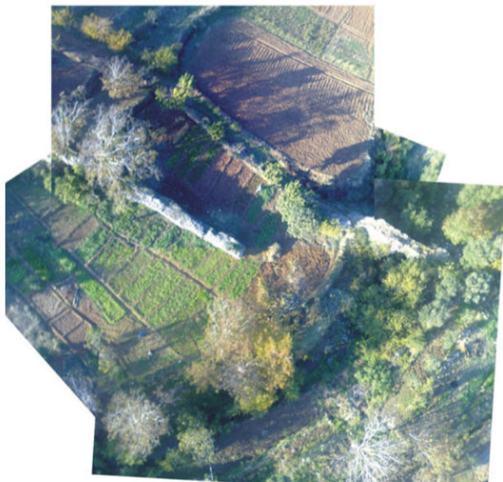
Рис. 7. Смещение римского акведука, произошедшее в результате катастрофического землетрясения 1170 г. н.э. (материалы беспилотной аэрофотосъемки, снимок предоставлен М. Рукие)
