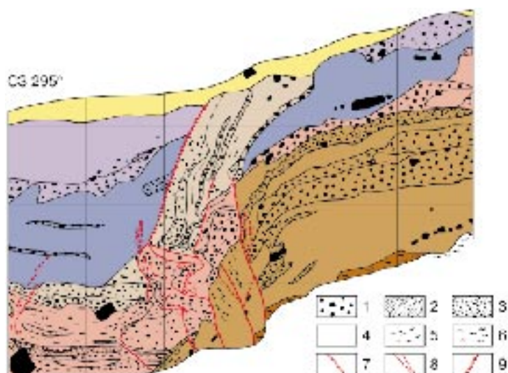
Рис. 3. Разрез канавы через Казерунский разлом, горы Загрос, Иран: 1 – камни, щебень и галька; 2 – гравий; 3 – песок с галькой или гравием; 4 – песок и суглинок; 5 – слоистость в песке или суглинке; 6 – гипс; 7 – ветви живого разлома; 8 – мелкие живые трещины; 9 – эродированный уступ живого разлома. Разным цветом показаны разновозрастные слои; верхний слой – современная почва. Вертикальные и горизонтальные линии проведены через 1 м
