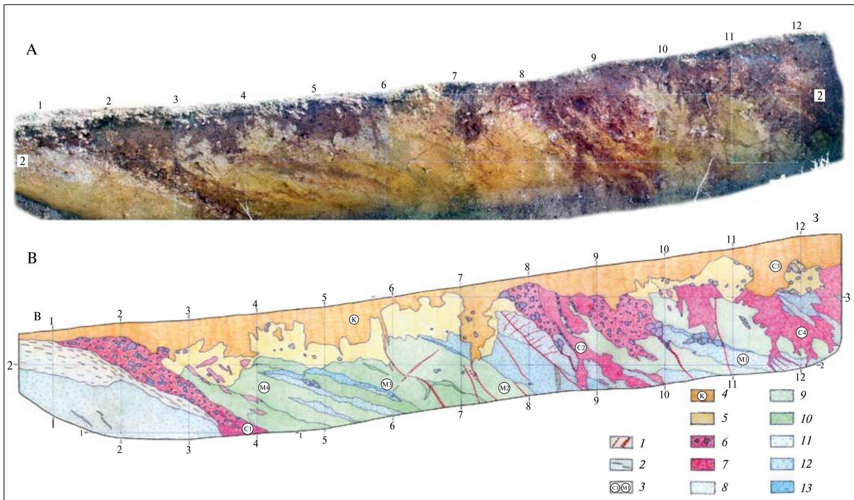
**Рис. 12.** Разрез южной стенки траншеи поперёк Левантского разлома
