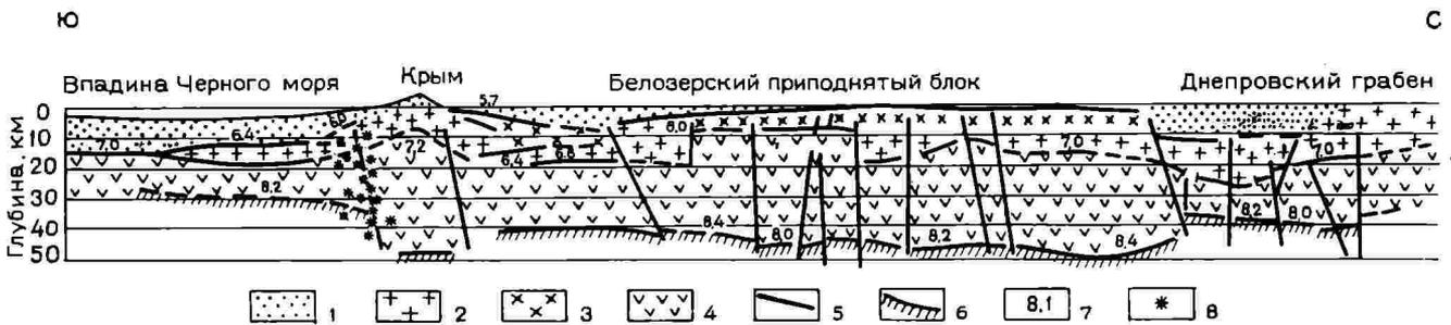
Глубинные разломы Украины (по С. И. Субботину и др., 1966 г.). Подошва земной коры и другие геологические границы до глубины 50 км расчленены системой почти вертикальных разломов на изогнутые ступени; к одному из разломов приурочены очаги зем-
