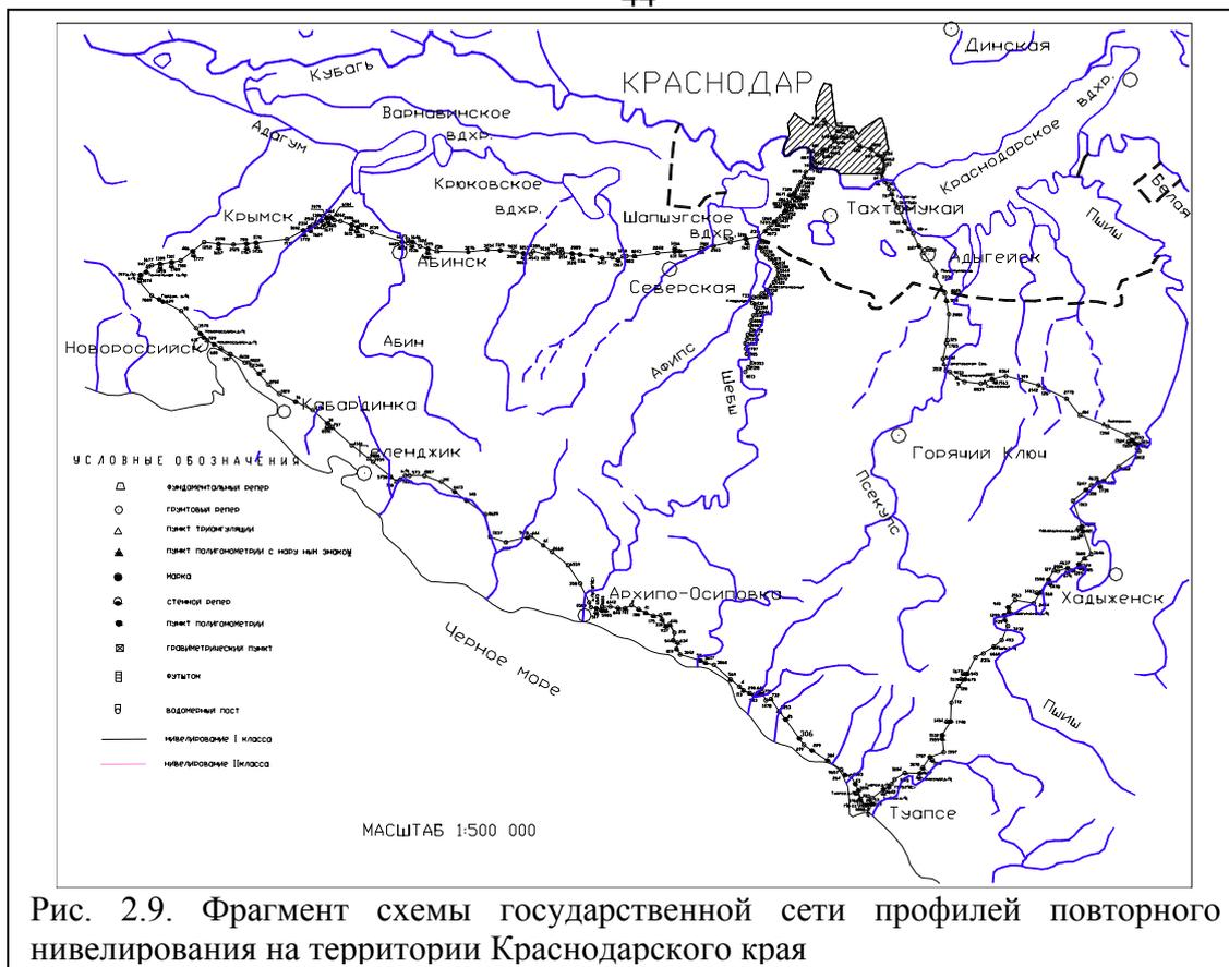
Рис. 2.9. Фрагмент схемы государственной сети профилей повторного нивелирования на территории Краснодарского края
