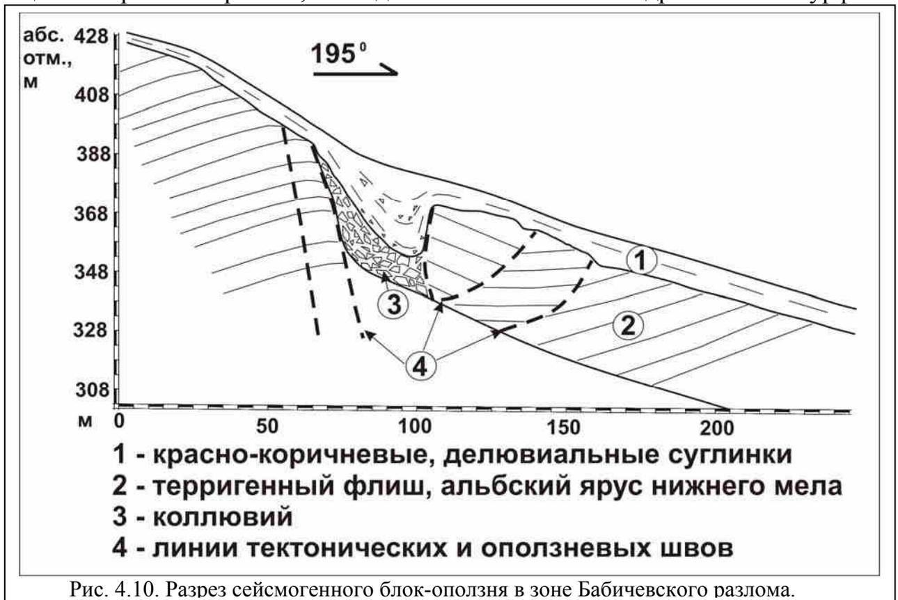
вскрыт тектонический уступ, приуроченный к одному из сместителей разломной зоны. Сам уступ имеет крутизну 20-25° и высоту около 40 м. На склоне уступа под маломощными делювиальными суглинками вскрыты дезинтегрированные породы флишевого переслаивания альбского яруса нижнего мела. В подножье уступа расположена относительно ровная площадка. Здесь шурфами на глубину до 3 м вскрыт мощный делювиальный шлейф, сложенный красно-коричневыми суглинками. Подошва шлейфа
