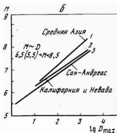
Р и с. 35. Зависимость длины отдельных разрывов l и длины зон разрывов L (а) и величины смещений по разрывам (б) от магнитуды землетрясений M в Средней Азии, на разломе Сан-Андреас, в Калифорнии и Неваде
