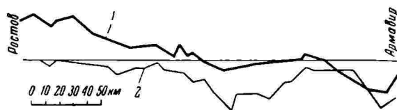
Рис. 3. Профили по линии Ростов — Армавир. 1 — кривая изменения скоростей современных движений, по данным повторного нивелирования; 2 — кривая, характеризующая геологическую структуру, по данным геофизической разведки
