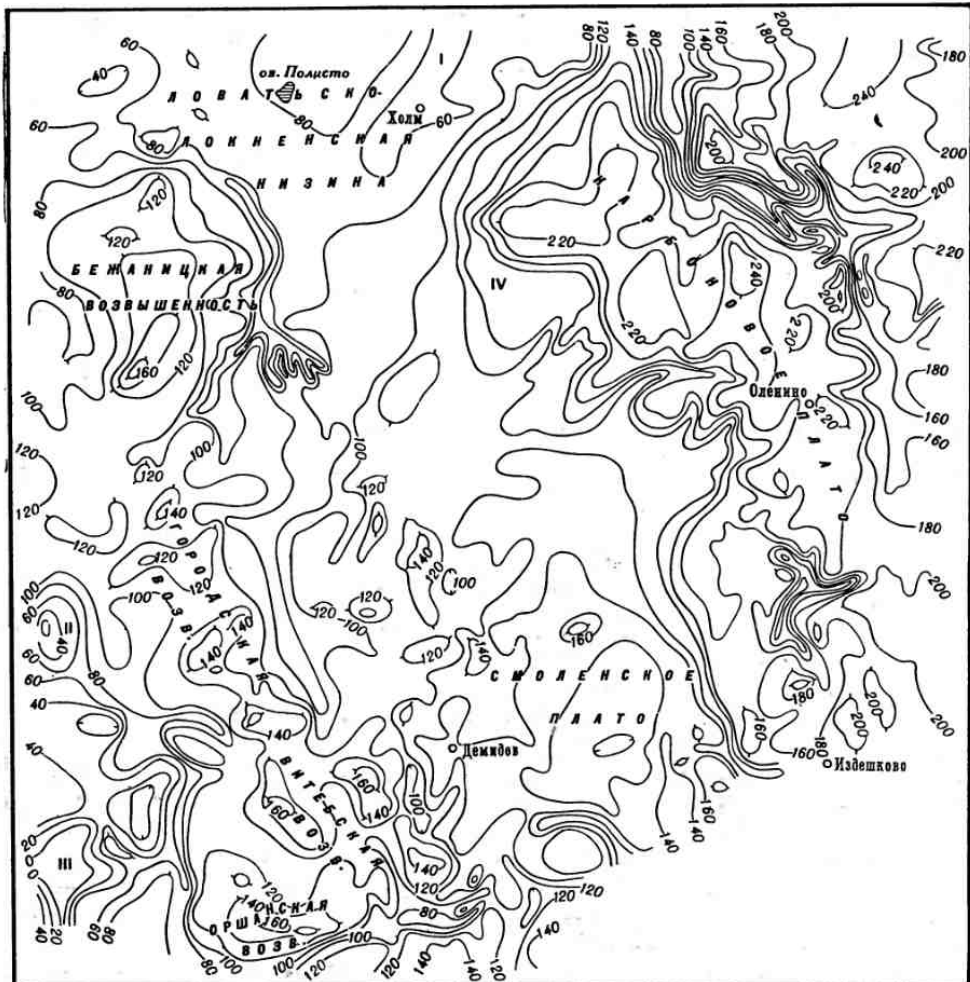
Схема поверхности коренных пород. Горизонтالي проведены через 20 м. Котловины: I — Холмская; II — Полоцкая; III — Чашникская. Возвышенности: IV — Торопецкая; V — Усмынско-Крестецкая
