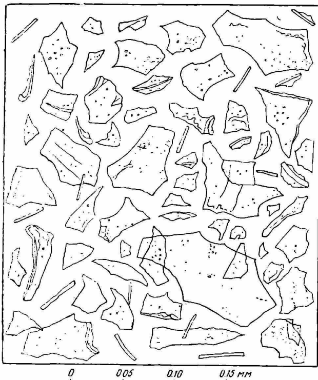
Форма частиц трахитандезитового вулканического пепла из последних отложений южной Молдавии, под микроскопом.
