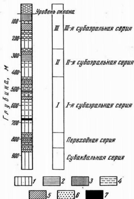
Рис. 8. Профиль канадской буровой скважины (генерализован) (по G. K. Muescke, S. A. Ade-Hall et al., 1974)
