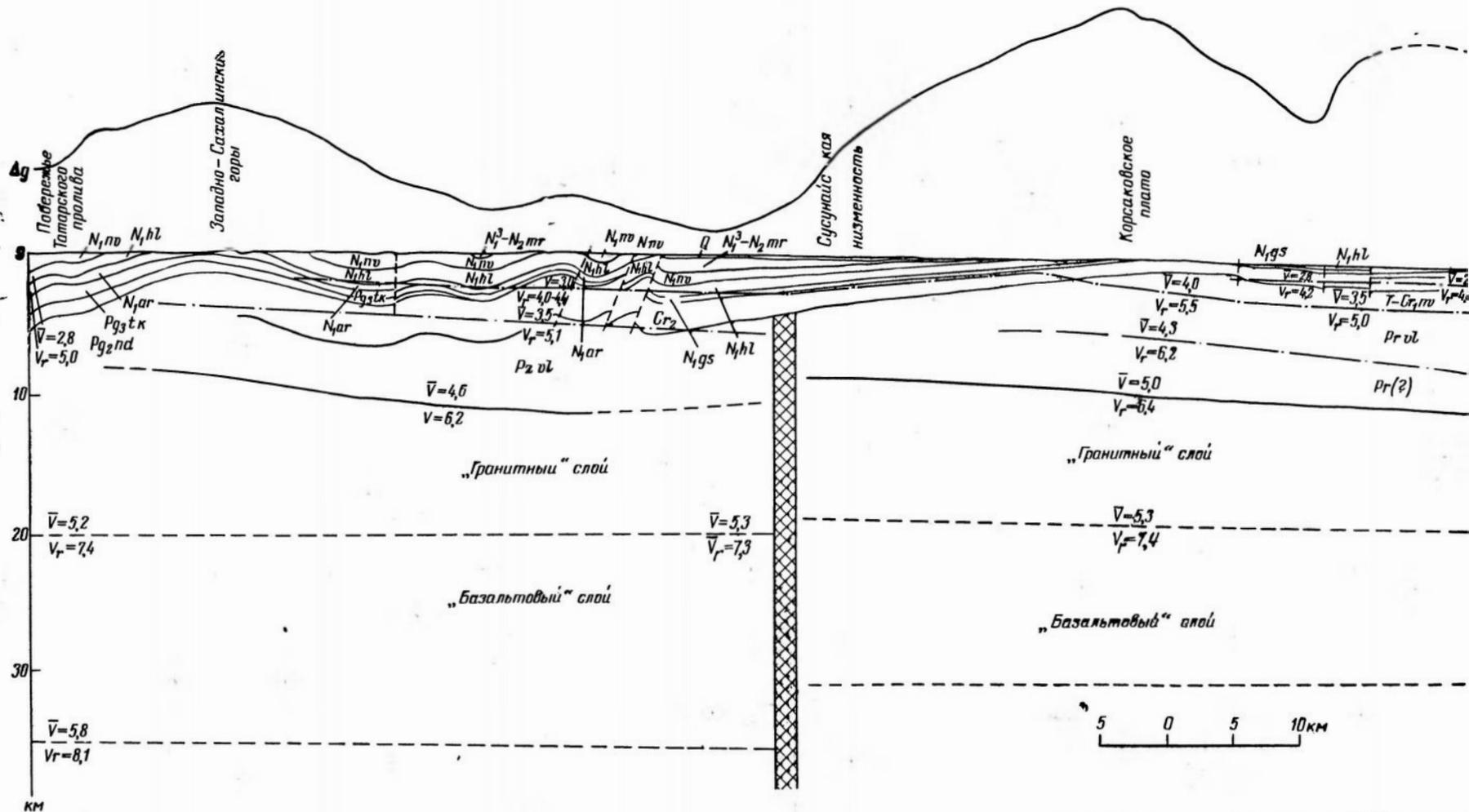
Рис. 2. Геолого-геофизический разрез через Южный Сахалин. Составлен С. М. Александровым и В. Н. Занюковым (материалы ГСЗ приводятся в сокращении). 1 — преломляющие горизонты: а) в нижней части земной коры, б) внутри осадочной толщи; 2 — стратиграфические границы; 3 — разрывные нарушения; 4 — граница раздела земной коры и мантии.
